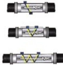
Figura 21 – Formas de posicionamento das sondas de medidor ultra-sônico
