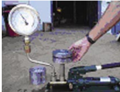
Figura 45 – Colocação de pesos calibrados na balança de peso morto
