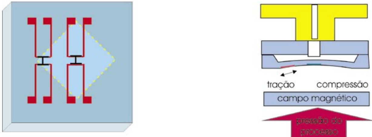
Figura 38 – Princípio de funcionamento do sensor de pressão diferencial de silício ressonante
