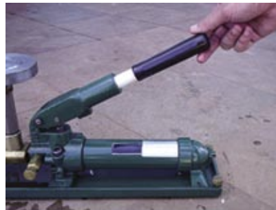
Figura 46 – Equilibrando a pressão para fazer flutuar a bandeja dos pesos
