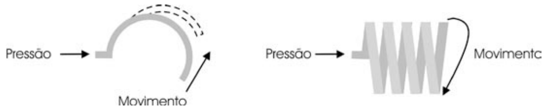
Figura 30 – Funcionamento do manômetro do tipo Bourdon
