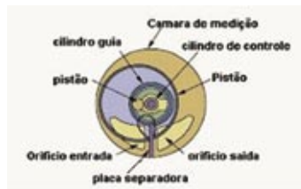
Figura 24 – Medidor volumétrico de pistão oscilante
