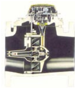
Figura 3 – Vista em corte – medidor Woltmann horizontal
